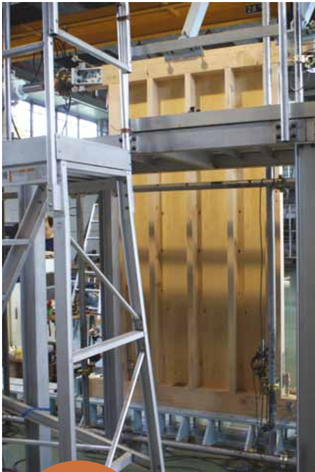
試験体の正面（上右）と背面（上左） 壁はロシアンバーチ、柱・梁・土台はカナダツガE 120
