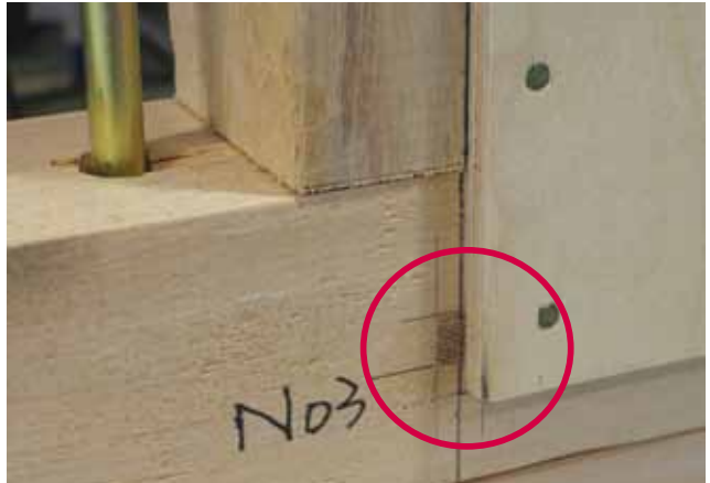
3体目の試験で-16kNで加力 右辺に2ミリずれた
