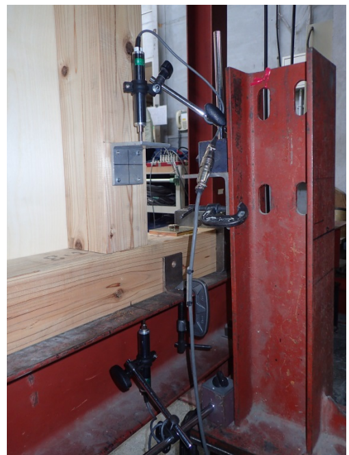
(f) 変位計設置状況 [DT4,DT6]
