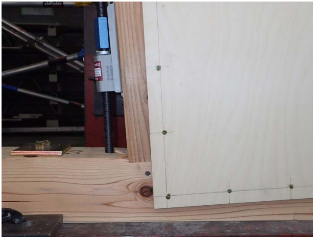
(a) 柱の土台へのめり込み
