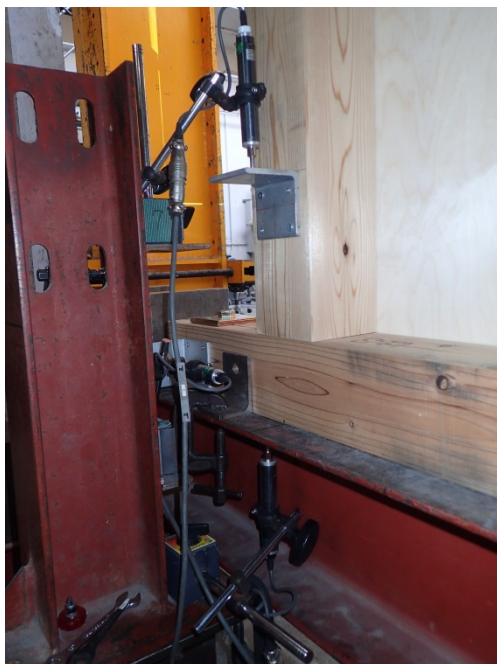
(e) 変位計設置状況 [DT2,DT3,DT5]
