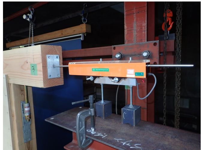
(d) 変位計設置状況 [DT1]
