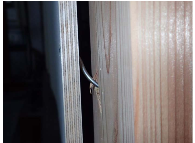
(b) 接合くぎ軸部の柱からの抜け出し
