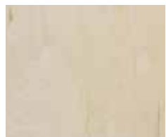
特徴: 節の補修が両面に あります。 B/BBと比べると 積層の抜け、 塗料の吸い込みが 多いです。 用途: カジュアルに 仕上げる時に。
